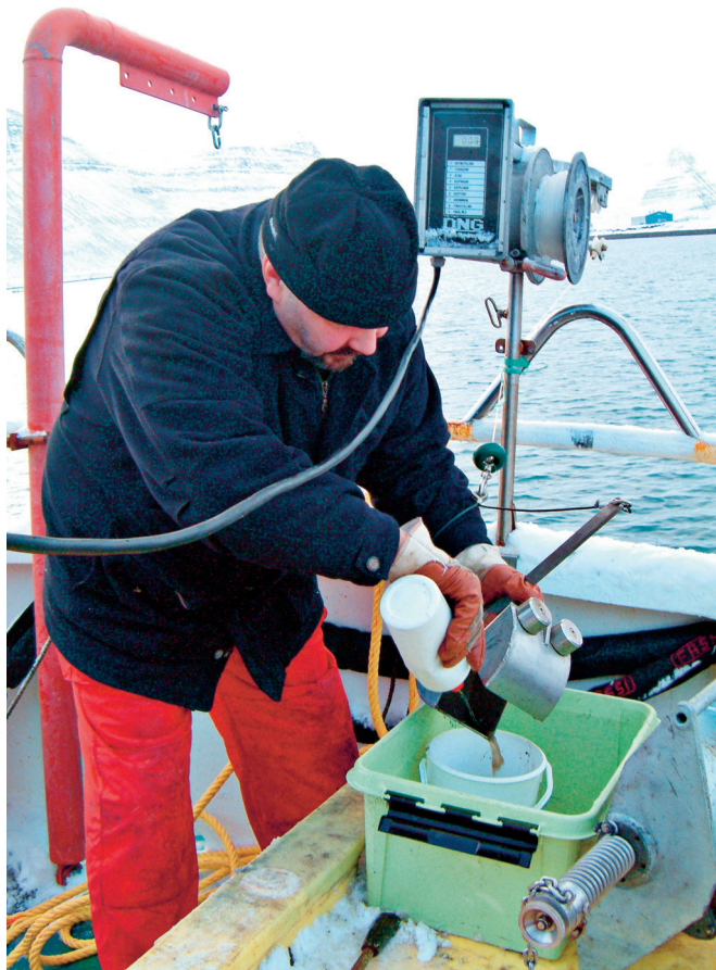
Mynd 7. Sýnataka með Van Veen greip.
